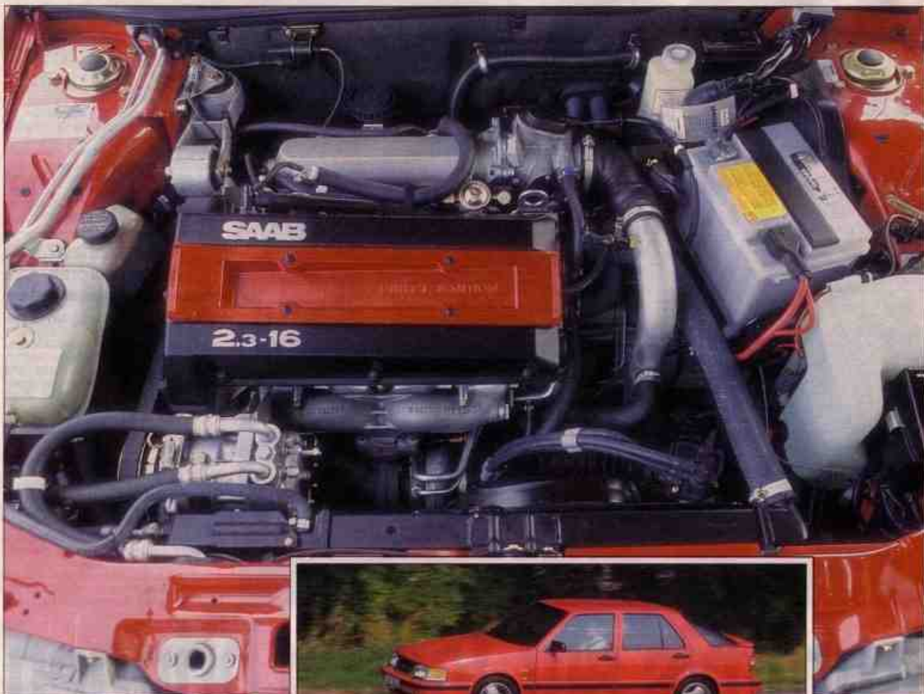
Der neue, 195 PS starke 2,3-Liter-Vierzylinder mit Vierventiltechnik und Turbolader ist die stärkste Motorisierung für den Saab 9000. Die Elastizität ist seine Schokoladenseite
